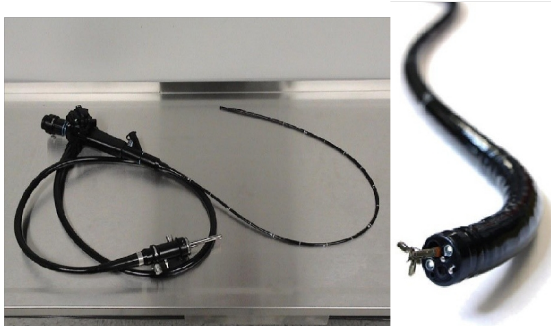
Vue d'ensemble d'un endoscope flexible standard (à gauche) et vue de la partie distale avec la caméra, les fibres optiques d'illumination et le canal opérateur dans lequel on trouve une pince à biopsie insérée
