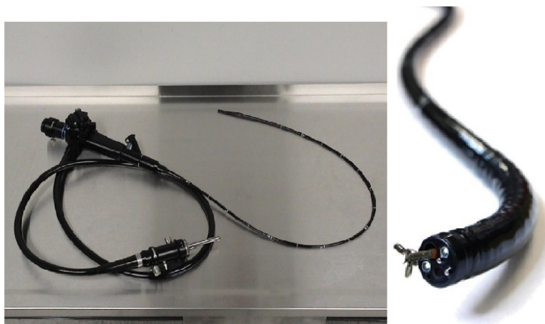
Vue d'ensemble d'un endoscope flexible standard (à gauche) et vue de la partie distale avec la caméra, les fibres optiques d'illumination et le canal opérateur dans lequel on trouve une pince à biopsie insérée
